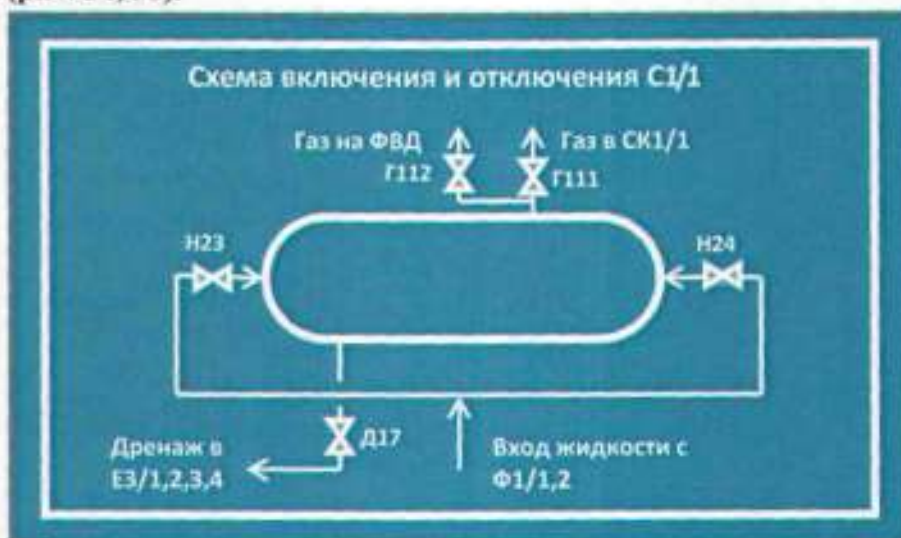
Рис. 33 Схема включения и отключения сосуда
