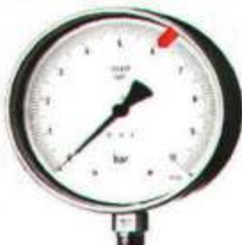
Рис. 31. Установка металлической пластины максимального разрешенного давления
