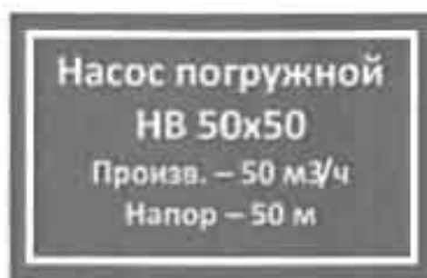
Рис. 63 Примечание: Буквы и кайма белые, фон синий, размеры таблички – 280х360 мм, высота букв – 70 мм, ширина каймы – 10 мм.
