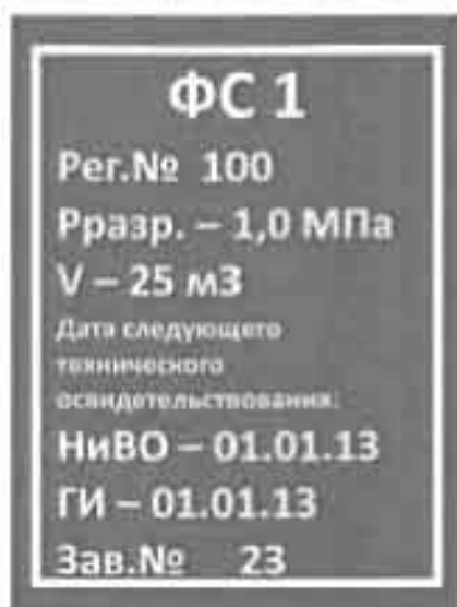
Рис. 61 Информационная табличка на факельный сепаратор Примечание: Буквы и кайма белые, фон синий, размеры таблички – 280х360 мм, высота букв – 70 мм, ширина каймы – 10 мм.
